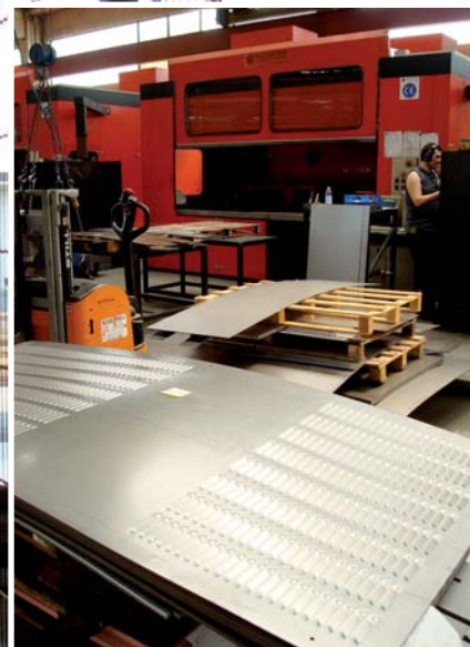
Una vista del magazzino centrale di stoccaggio delle lamiera e dei semilavorati realizzato da ANTIL. Sopra una delle cinque punzonatrici che costituiscono il cuore produttivo della MI-FRA.
